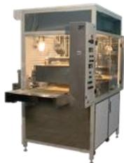
**Машина для глазирования с выкатной ванной МГ на жгутовом конвейере** предназначена для механизации процесса глазирования кондитерских изделий шоколадной глазурью на предприятиях пищевой промышленности. Так же основная конструктивная задача данной машины глазирования обеспечить чистое дно без следов глазури (глазирование куличей, тортов, кексов, ТОЛЬКО ВЕРХ ИЗДЕЛИЯ).
